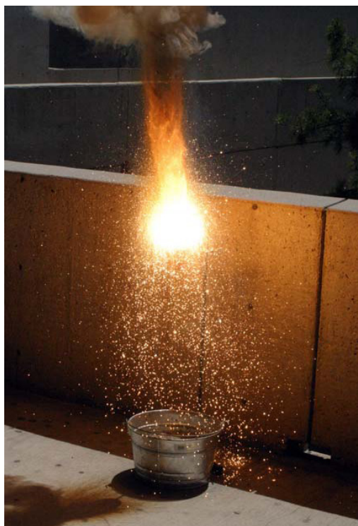
Figure 18 : Illustration d'une réaction thermitique convertissant un mélange ( Fe_2O_3 + Al ) en alumine ( Al_2O_3 ) + fer
