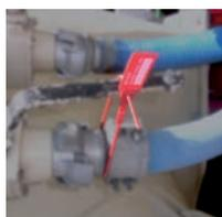
Scellé à longueur réglable avec tige cylindrique de 2 mm de diamètre.
