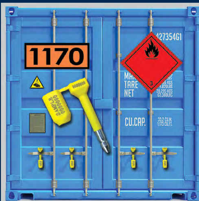
Plaque-étiquettes IMDG, panneaux orange et scellés
