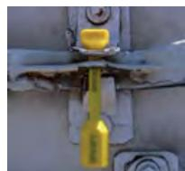
Connu sous le nom de « Scellé clou » ou « Scellé bouteille ». Conforme à la norme 17712.
