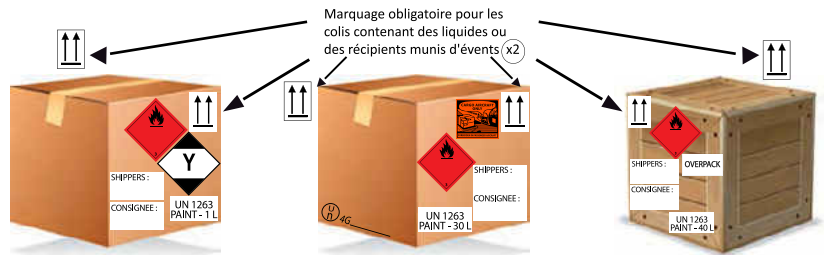
Etiquette 10x10 cm (ou 5x5 cm si le colis est de petite taille) Emballage non homologué
